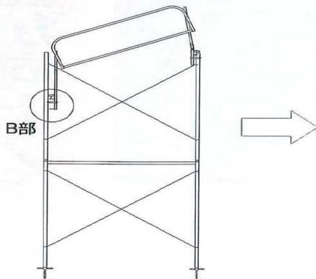
⑧ B部(左側)を二段目の建枠に取付ける。
