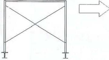
② 建枠を一段分組立てた状態で金具がついた側を内側にして右側よりセットする。
