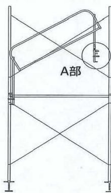
⑥ A部(右側)を二段目の建枠に取付ける。
