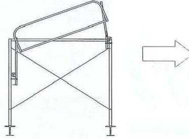
③ 左側の金具を持ち上げ建枠にセットする。
